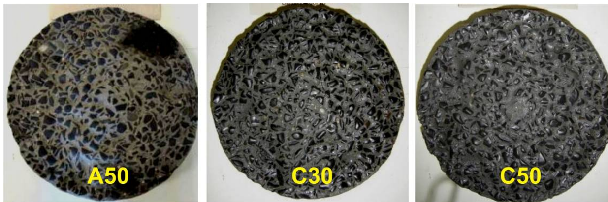
Figura 4.20. Corpos de prova de concreto submetidos ao ensaio de abrasão, após 72 h
