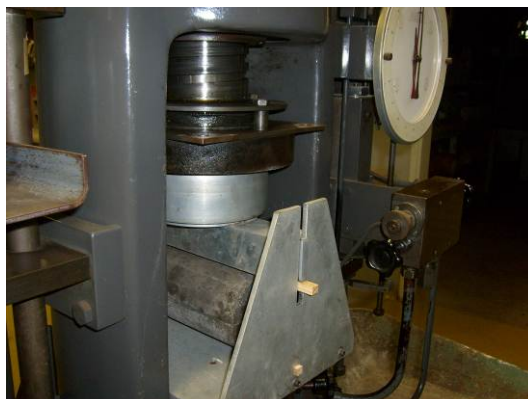
Figura 3.15. Montagem do apoio ao corpo de prova para ensaio de tração por compressão diametral.
