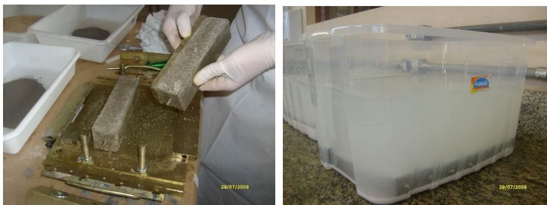
Figura 3.10. Ensaio de retração por secagem - desmoldagem dos corpos de prova depois de 24 horas (esq.); Cura inicial em água saturada com cal (dir.)
