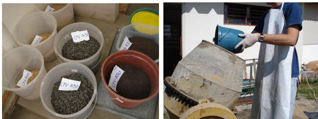
Figura 3.12. Separação e mistura dos materiais na betoneira.
