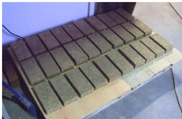
Fig. 1. Secagem dos blocos após a moldagem
