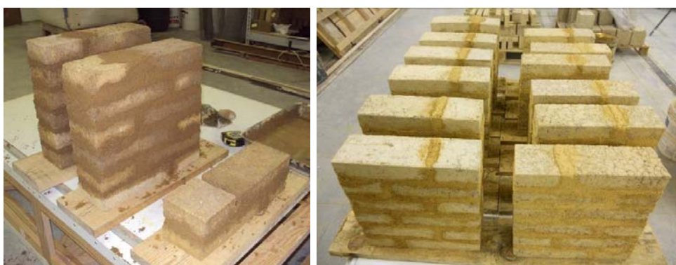
Fig. 5. Produção dos prismas (esquerda); e período de cura, com ventilação e temperatura controladas (direita).
