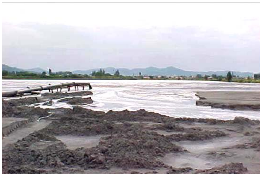
Figura 2.18. Disposição final das cinzas em bacias de decantação. Fonte: ANDRADE, 2004.
