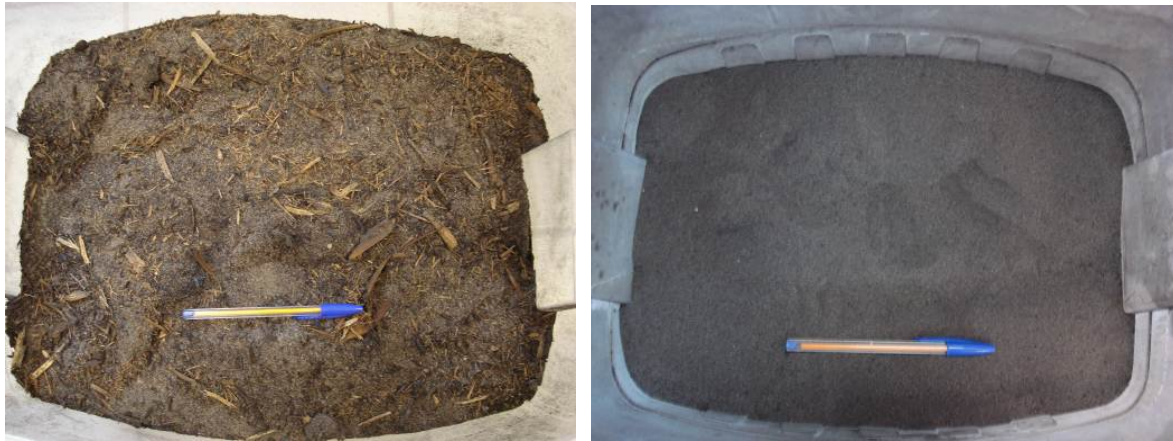
Figura 3.6. Aspecto visual da CBC antes (esq.) e após a moagem (dir.)
