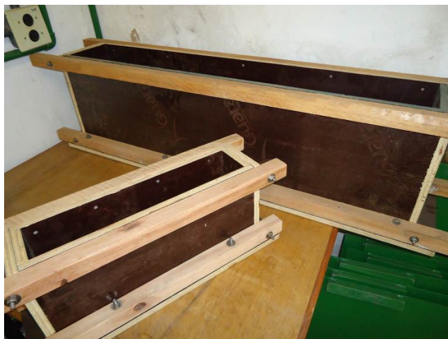
Figura 3.23. Formas produzidas para a moldagem das guias de pavimentação
