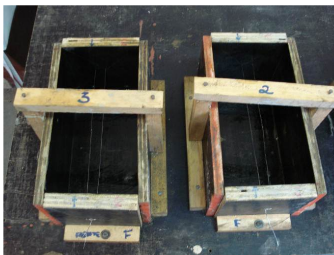
Figura 3.18. Montagem dos fios paralelos nas formas de madeira.
