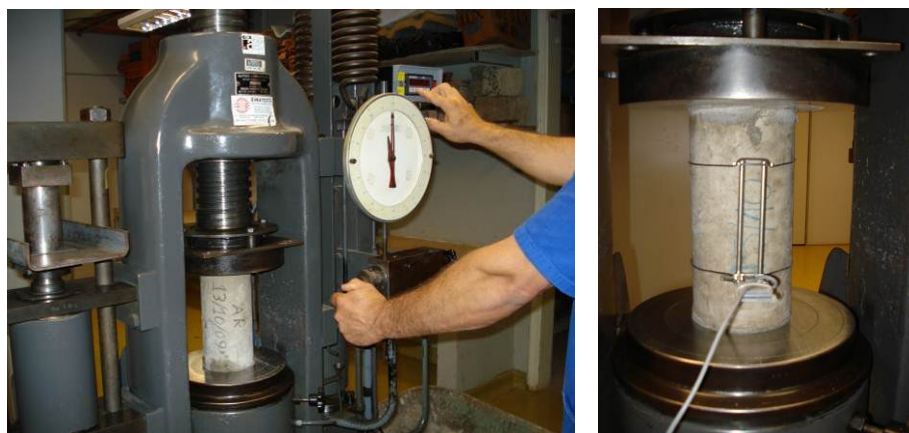
Figura 3.14. a) Ensaio de resistência à compressão axial (esq.); b) Transdutores elétricos acoplados ao corpo de prova para medição do deslocamento longitudinal (dir.).
