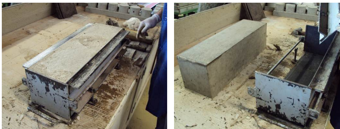
Figura 3.21. Desmoldagem dos prismas, após 72 horas.
