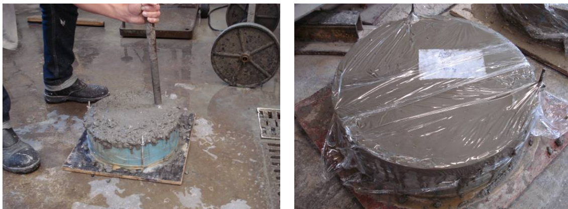
Figura 3.16. Moldagem dos corpos de prova para o ensaio de abrasão
