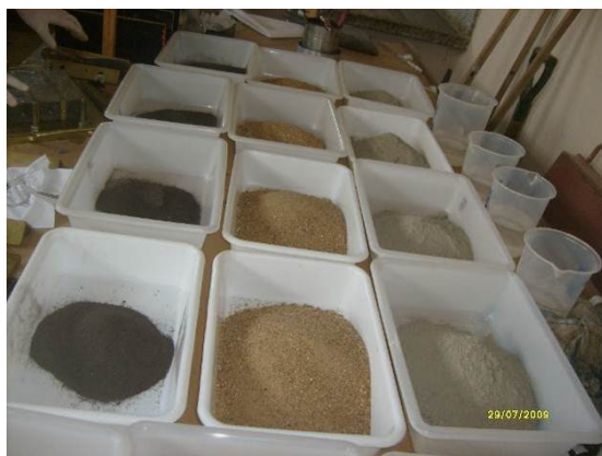
Figura 3.9. Materiais utilizados na moldagem das argamassas para o ensaio de resistência à compressão
