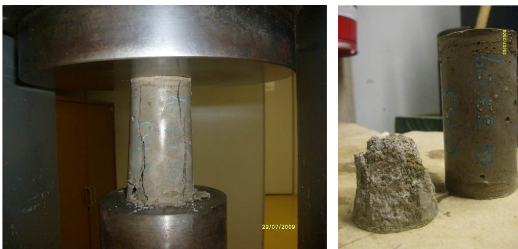
Figura 4.8. Ruptura dos corpos de prova de argamassa – modelo cônico
