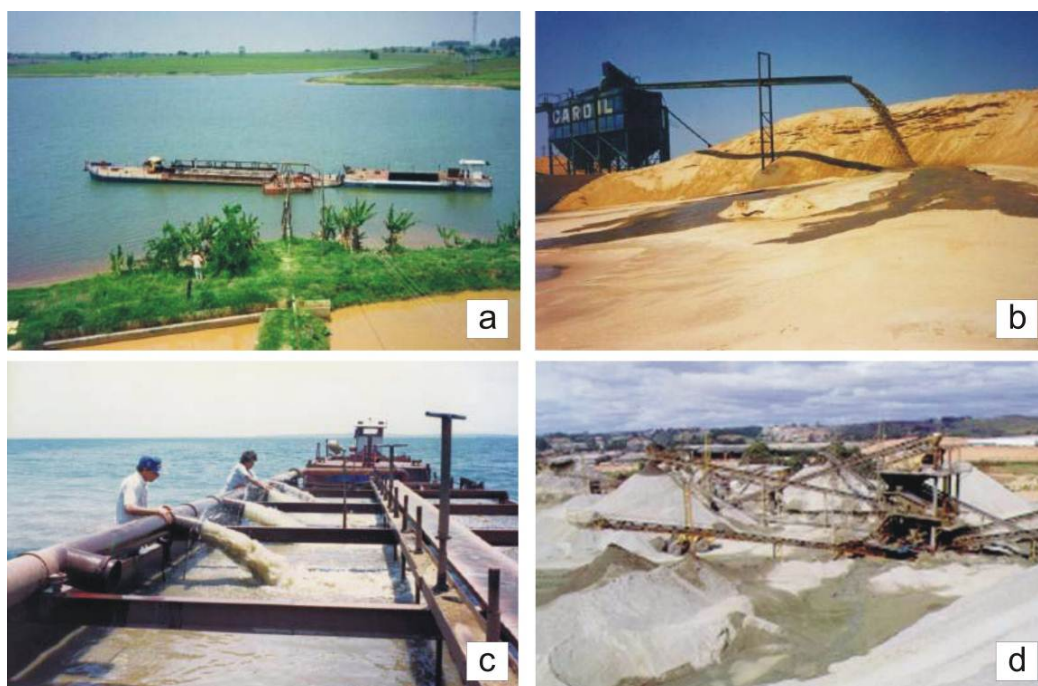
Figura 2.12. Sistema de mineração da areia extraída de rios: (a) e (b) barcaça extraíndo a areia; c) silo de estocagem de areia; e d) separação e controle no areal. Fonte: RODRIGUES, 2005.
