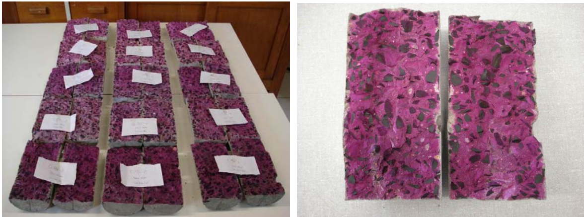
Figura 4.17. Corpos de prova rompidos e tratados com a fenolftaleína – ensaio de carbonatação natural
