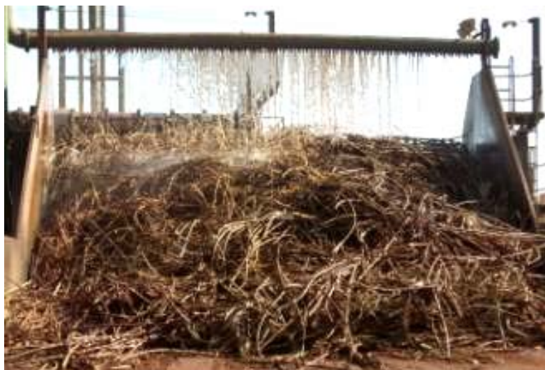
Figura 2.4. Lavagem da cana-de-açúcar para retirada de impurezas. Foto: Patrícia Cândida Lopes. Fonte: Agência EMBRAPA, 2010.
