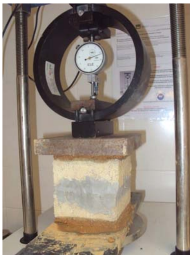
Fig. 2. Ensaio de resistência à compressão dos blocos
