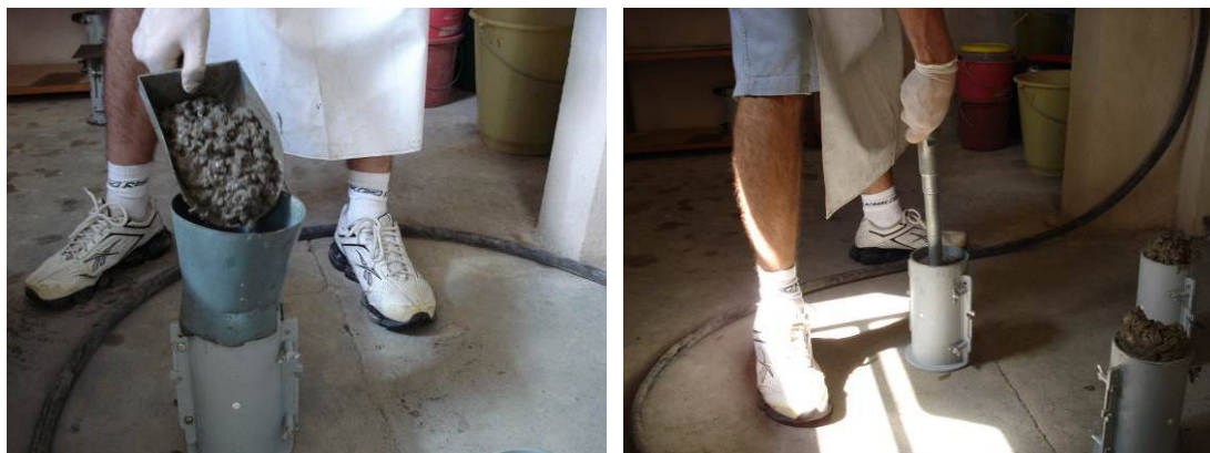
Figura 3.13. Moldagem e adensamento dos corpos de prova.
