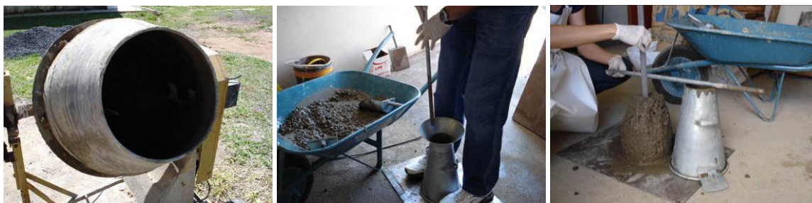
Figura 4.9. Etapas, em laboratório, dos testes realizados para os ajustes nos traços de concreto
