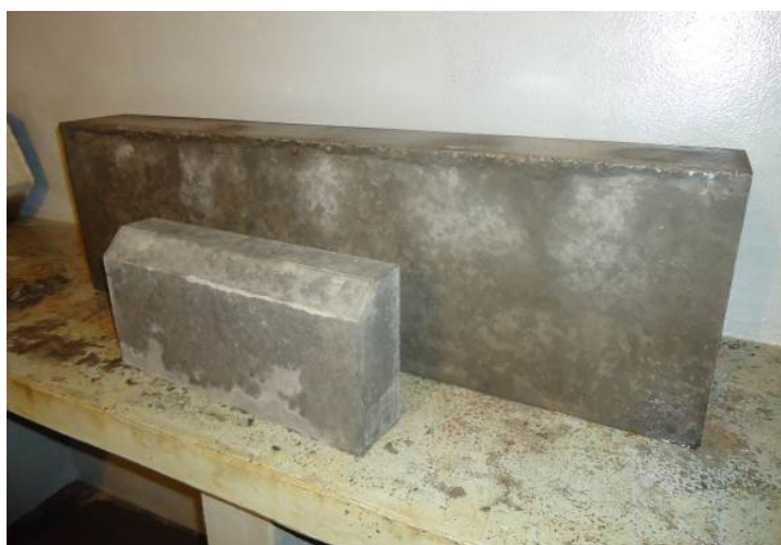
Figura 4.24. Guia e miniguia depois da desmoldagem
