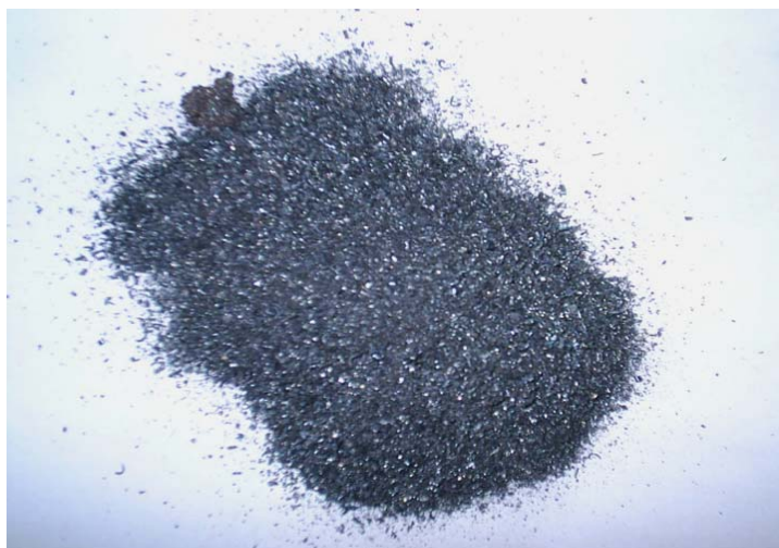
Figura 2.15. Resíduo de ferro usado como substituto da areia. Fonte: Ismail e Al-Hashmi, 2008b
