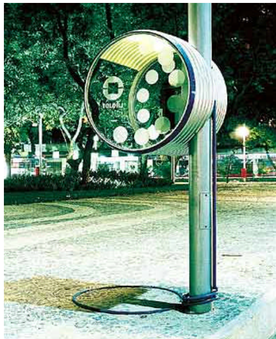
Figura 14 – Telefone público com sinalização ao nível do solo, para auxílio de deficientes visuais (Projeto Rio Cidade).
