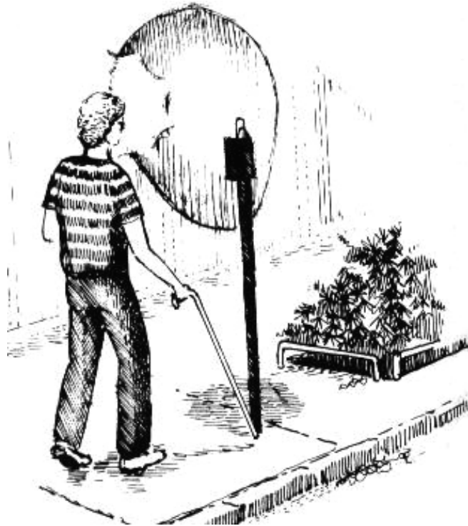
Figura 6 – Barreira vertical percebida pelo cego tarde demais, atestando a qualidade física do ambiente urbano, no aspecto acessibilidade.
