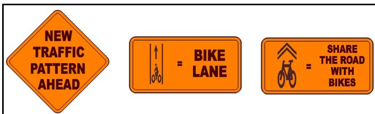
Figura 7.22: Sinais avisando e explicando nova sinalização.
