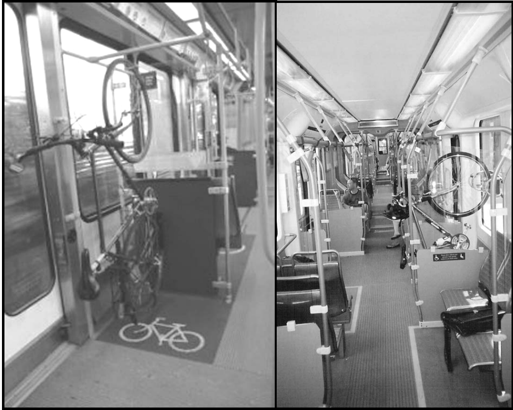
Figura 8.8: Bicicletas acomodadas em áreas e suportes específicos de um vagão de trem.
