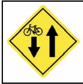
Figura 7.25: Sinal indicando tráfego de bicicleta no sentido contrário ao dos veículos motorizados.
