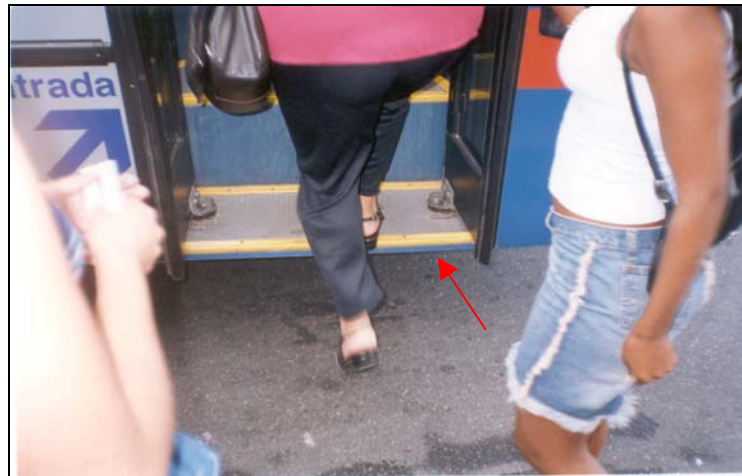
Figura 3.11 – Altura do degrau ao solo de um tipo ônibus que circula na cidade de Santos (Porta dianteira)
