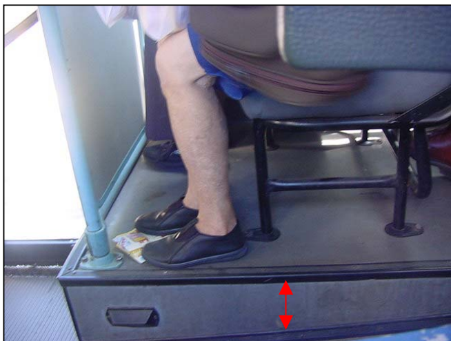
Foto nº 9 Detalhe da altura do piso, onde estão localizadas as poltronas
