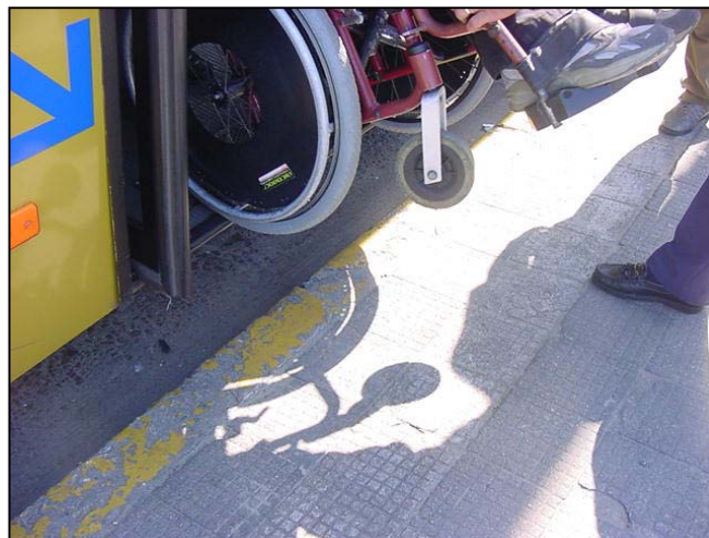
Figura 5.1 – Ônibus carroceria Caio com plataforma de acesso para deficientes que não chega ao nível da rua.
