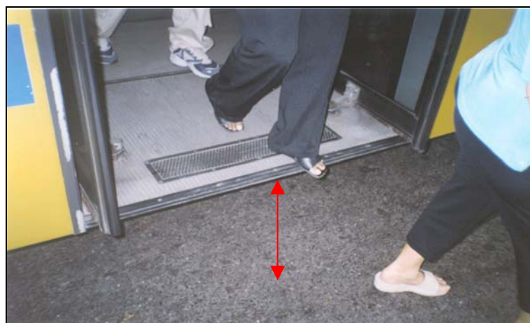
Figura 3.10 – Altura da plataforma ao solo de um tipo de ônibus que circula na cidade de Santos (Porta do meio)
