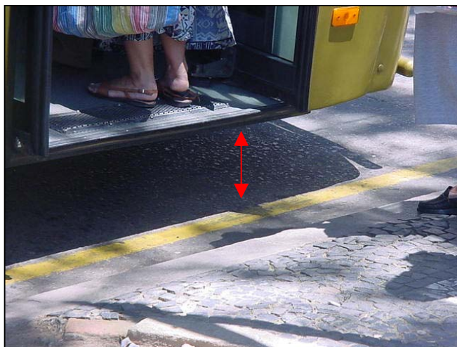
Foto nº14 Detalhe da altura da plataforma porta de entrada
