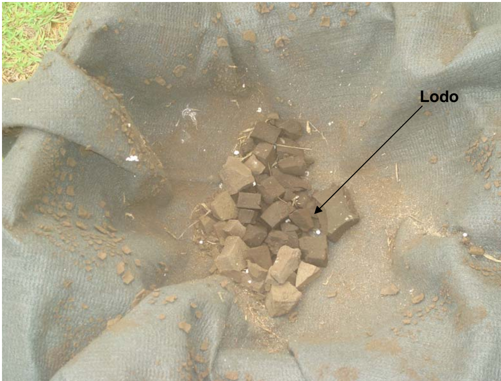
Figura 4.3- Foto do material em processo de secagem- Lodo proveniente de tratamento que utiliza Cloreto de Polialumínio como coagulante químico
