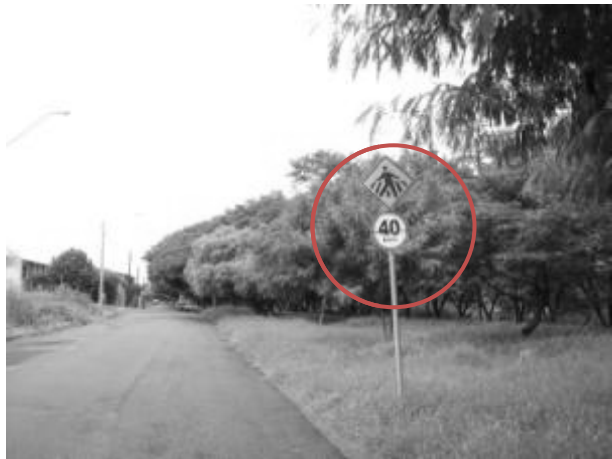
Foto E5-10 Indicação de travessia sem sinalização horizontal
