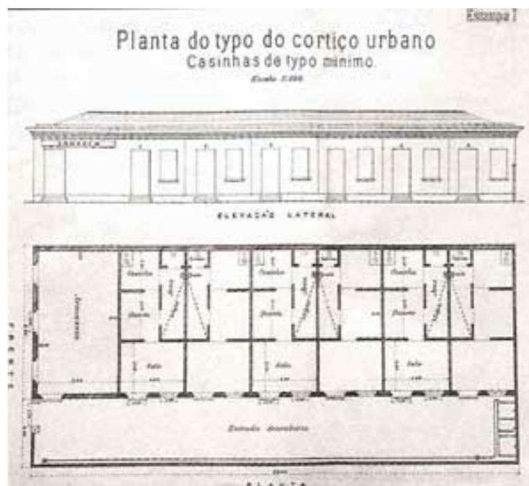
Figura 2-3 Planta do tipo do cortiço urbano - Casinhas de tipo mínimo, propostas pela Comissão de Exame e Inspeção dos Cortiços, (1893).
