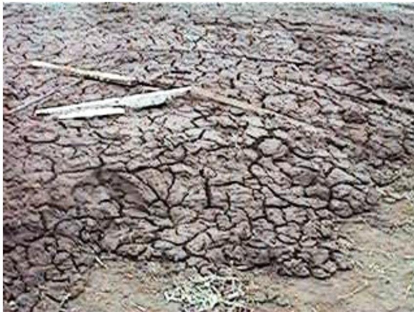
Figura 09 - Lagoa de lodo após remoção de água - ETA Rio Claro - SP - Fonte: Achon (2008).
