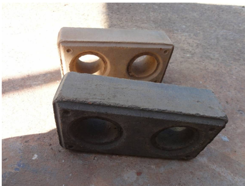
Figura 30 - Bloco cerâmico sem a adição de lodo e a frente com adição de lodo de ETA. Fonte: BioCiclo (2010).
