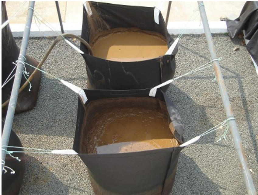
Figura 26 - Disposição dos “bag”s verticais e abertos, sendo utilizados para o desaguamento do lodo na ETA. Fonte: Pessoa (2007).
