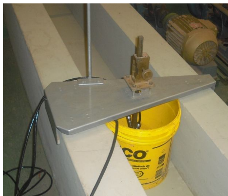
Figura 22: Verificação das medidas de nível de água do equipamento eletrônico
