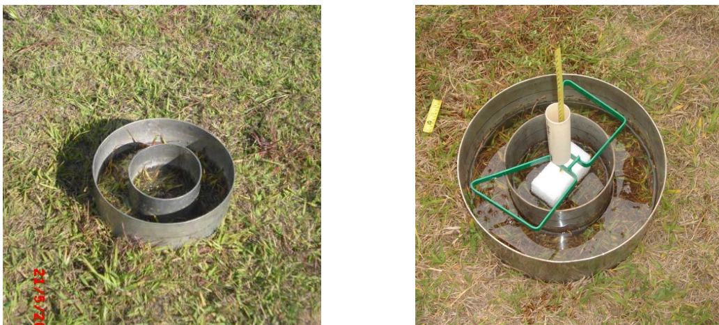
Figura 19: Anéis concêntricos instalados em campo
