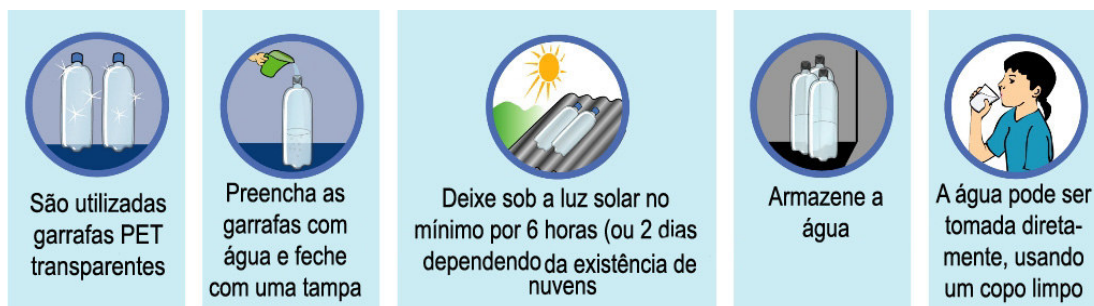
FIGURA 2.5.38 - Procedimento do método SODIS - Consiste em deixar a água não tratada em exposição a luz solar pelo período mínimo de 6 horas
