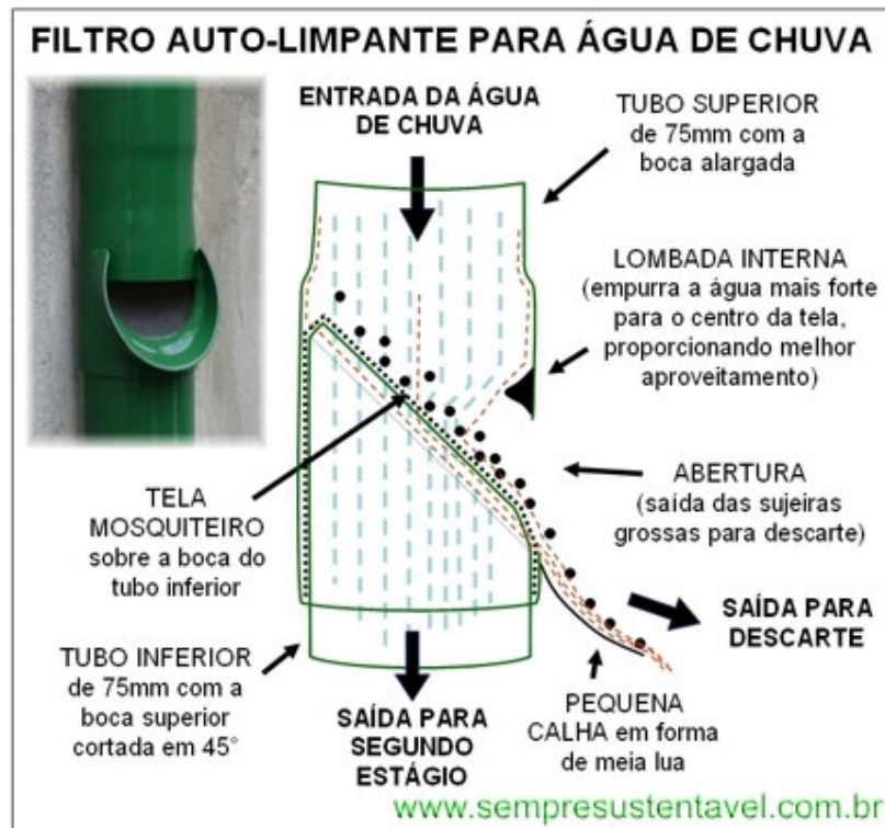
FIGURA 2.5.34 - Esquema de funcionamento do filtro auto-limpante (SEMPRE SUSTENTÁVEL, 2011)
