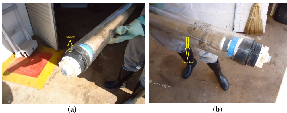
Figura 22 – Amostrador de lodos: (a) Êmbolo, (b) Cano PVC Fonte(SABESP, ETE-Limoeiro / Presidente Prudente-SP)
