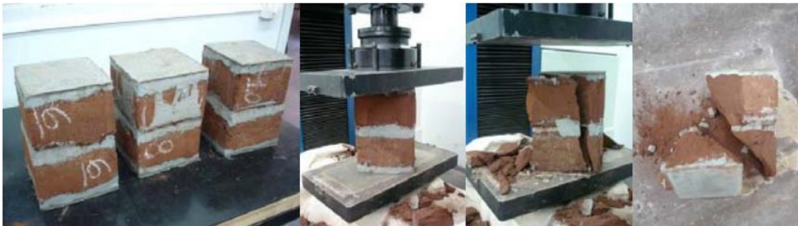
Figura 30: Determinação da resistência à compressão e flexão dos corpos de prova (adobes).
