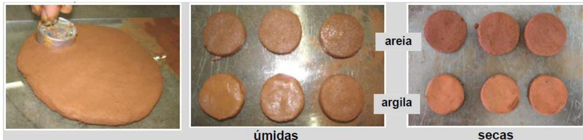
Figura 27: Teste de resistência seca. Observando-se a diferença de retração entre a terra arenosa e a argilosa.
