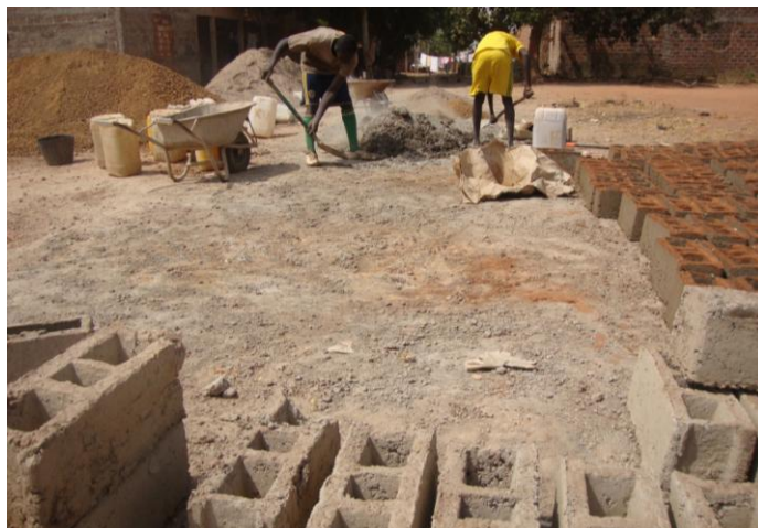
Figura 50: Produção manual (artesanal) de blocos de concreto para a construção habitacional.
