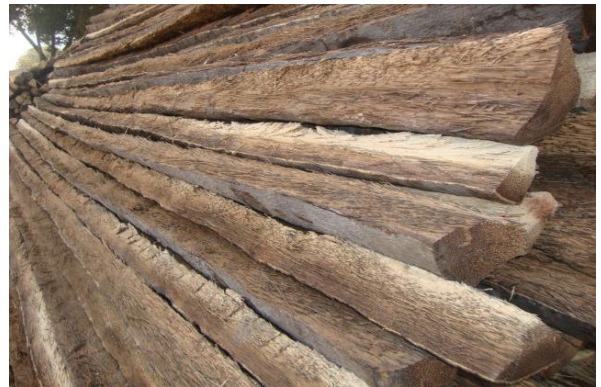
Figura 10: Rachas (barras) de palmeira ( cibe ) prontas para construções das estruturas.
