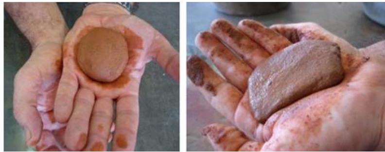
Figura 24: Teste de exsudação: diferença entre uma terra argilosa (à esquerda) e uma terra arenosa (à direita).
