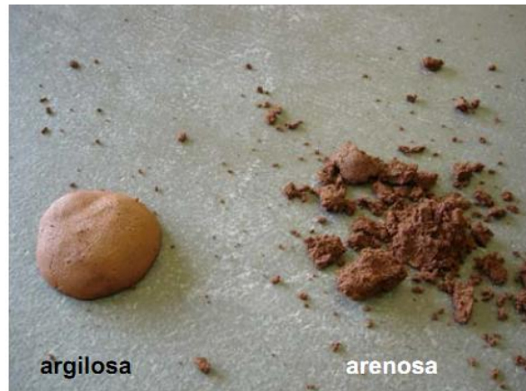
Figura 23: Espalhamento da bola de terra após o teste da queda de bola.
