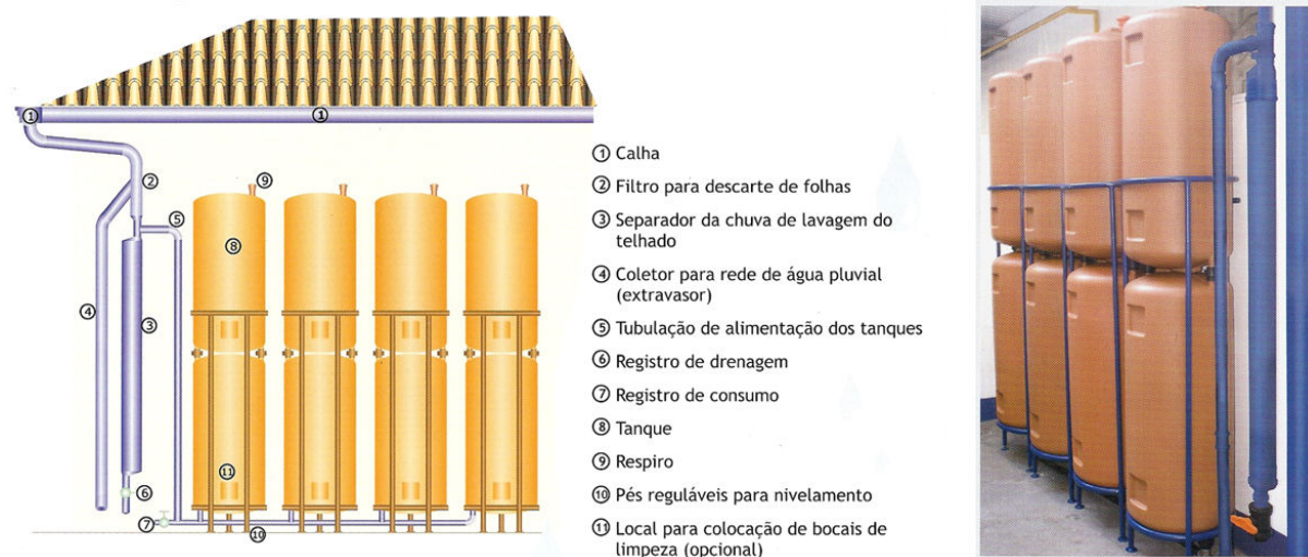
Figura 29: Microrreservatório EcoRain. Fonte: Alpina Termoplásticos, 2010.
