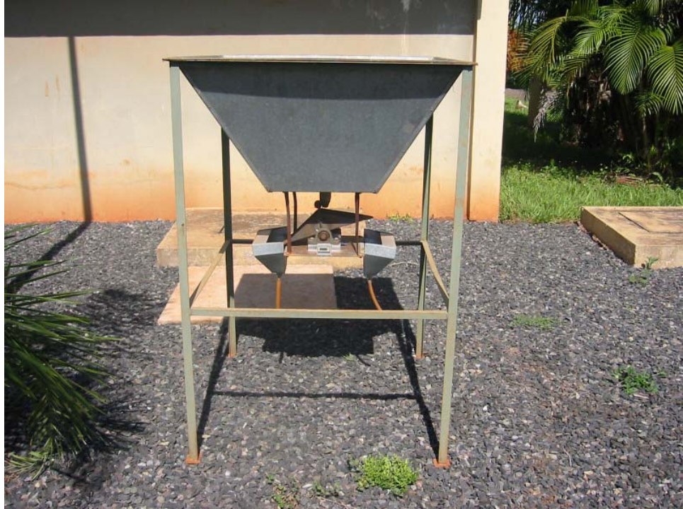
FIGURA 5.2 Protótipo de Leito de Drenagem desenvolvido por CORDEIRO (2001)
