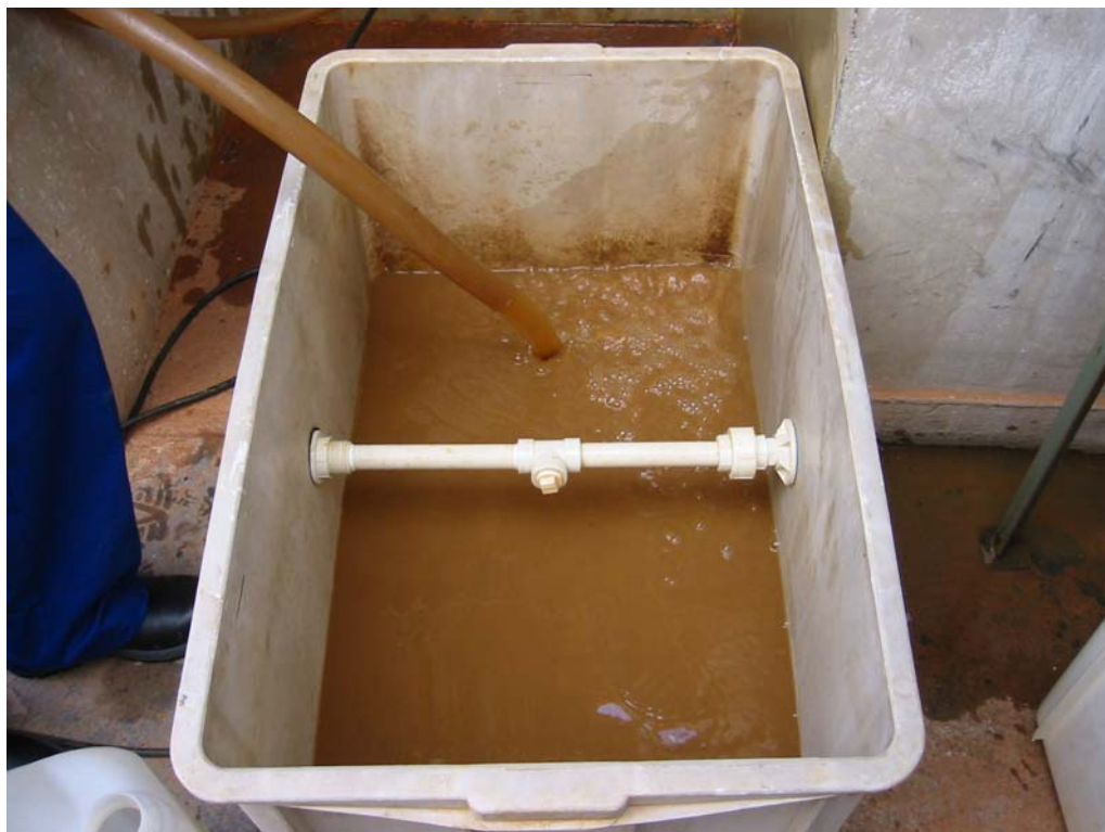
FIGURA 5.5 Coleta de água de lavagem de filtro para ensaios e análises
