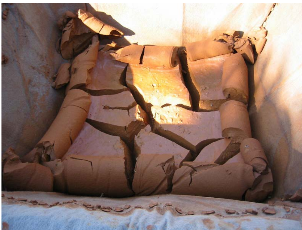
FIGURA 6.2 Aspecto do lodo aplicado no protótipo de Leito de Drenagem após drenagem da água livre
