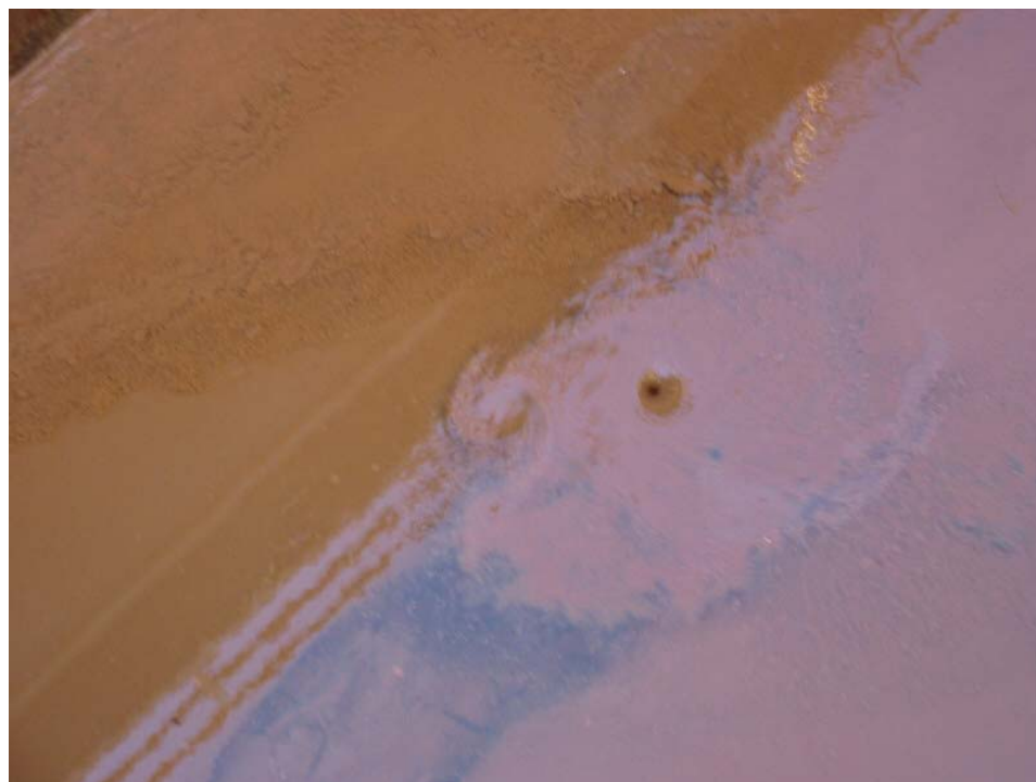
FIGURA 5.3 Interface da camada clarificada e o lodo no processo de descarga
