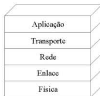
Figura 2.6 – Pilha de Protocolos da RSSF. (Adaptado de [AKY 02])
