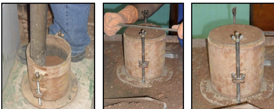
Figura 3.5 - Ensaio de Compactação
