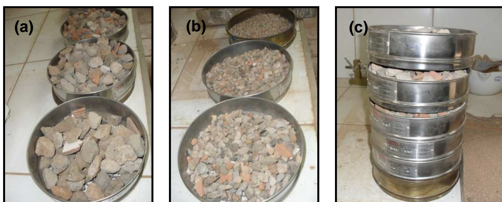
Figura 3.4 - Ensaio de granulometria: (a) e (c) BGS reciclada de RCC mistos; (b) bica corrida reciclada de RCC mistos.
