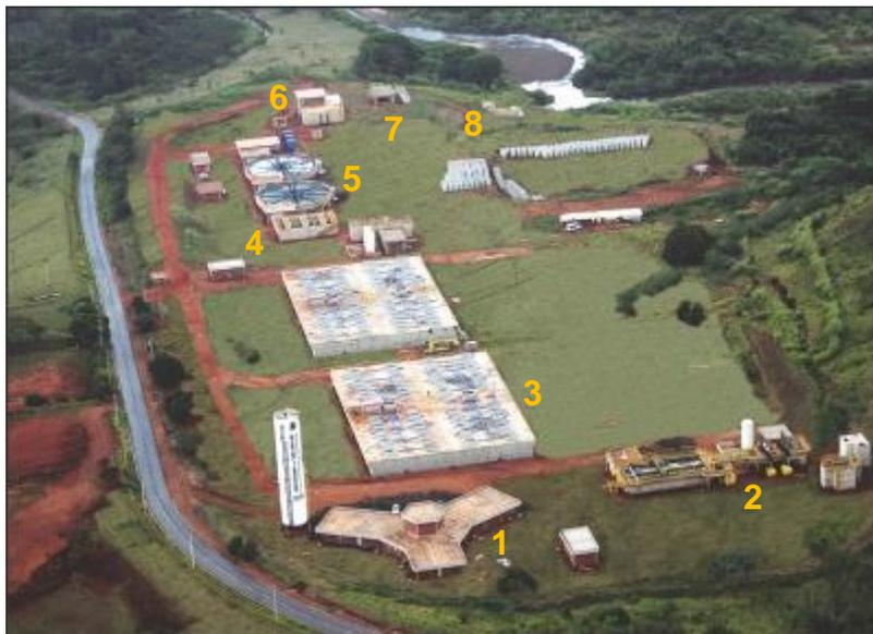
**Fonte:** Disponível em:< [www.deltaconstrucao.com.br](http://www.deltaconstrucao.com.br)>. Acesso em: 29 maio 2013. 1 - Bloco administrativo; 2 - Tratamento preliminar; 3 - Reatores UASB; 4 - Floculação; 5 - Flotação; 6 - Desaguamento de lodo; 7 - Desinfecção por UV; 8 - Pós-aeração.
