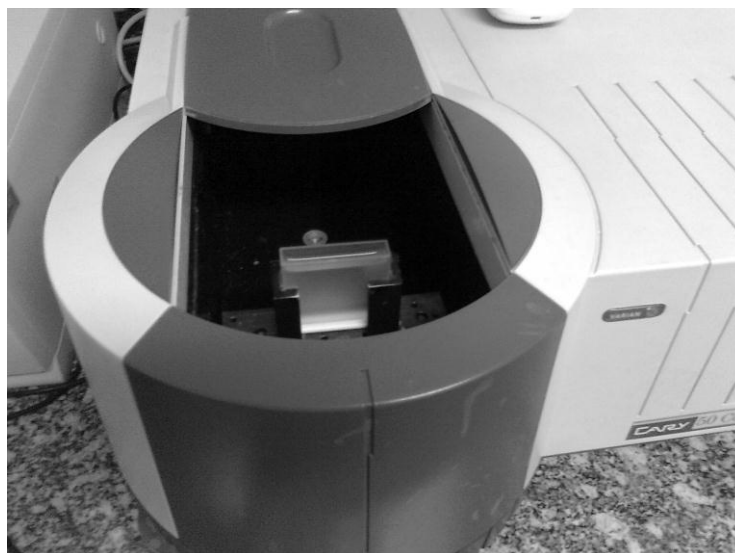
Imagem 10: Espectrofotômetro UV utilizado para a leitura do fósforo total.
