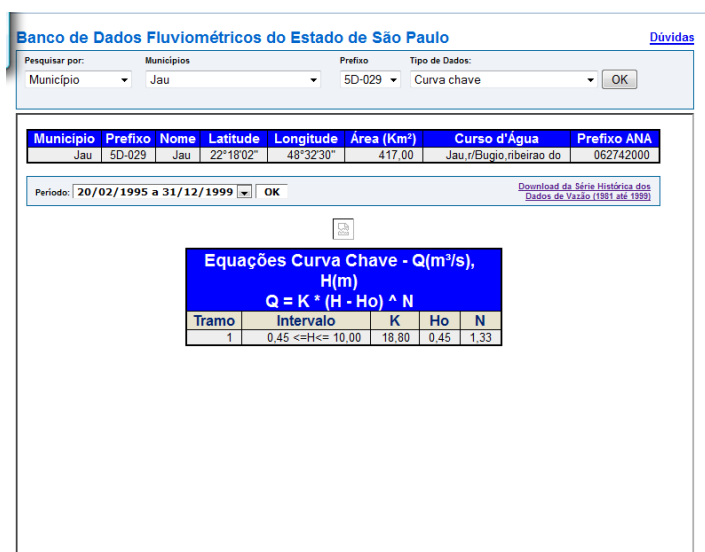
Figura 31- Tela do Banco de Dados Fluviométricos do Estado de São Paulo – Posto 5D-029 – Equação da curva-chave Fonte: DAEE, 2014
