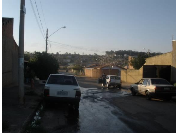
FOTOS B.2.48., B.2.49., B.2.50. e B.2.51. Água escorrendo sobre a pavimentação asfáltica, não captada pelas bocas de lobo (foto do autor).
