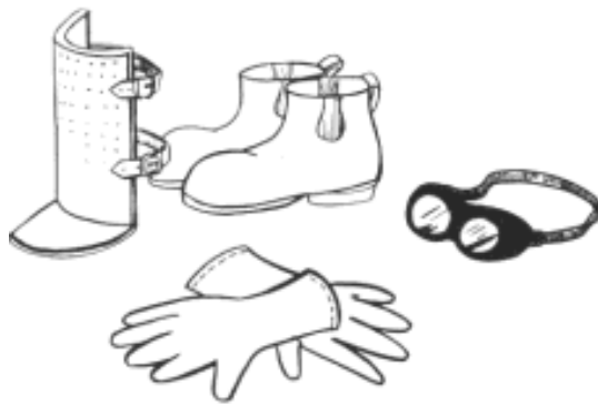
Figura A5.1: Equipamentos de Proteção Individual (EPI's) (Fonte: www.ufrrj.br/institutos/it/de/acidentes/epi.gif )
