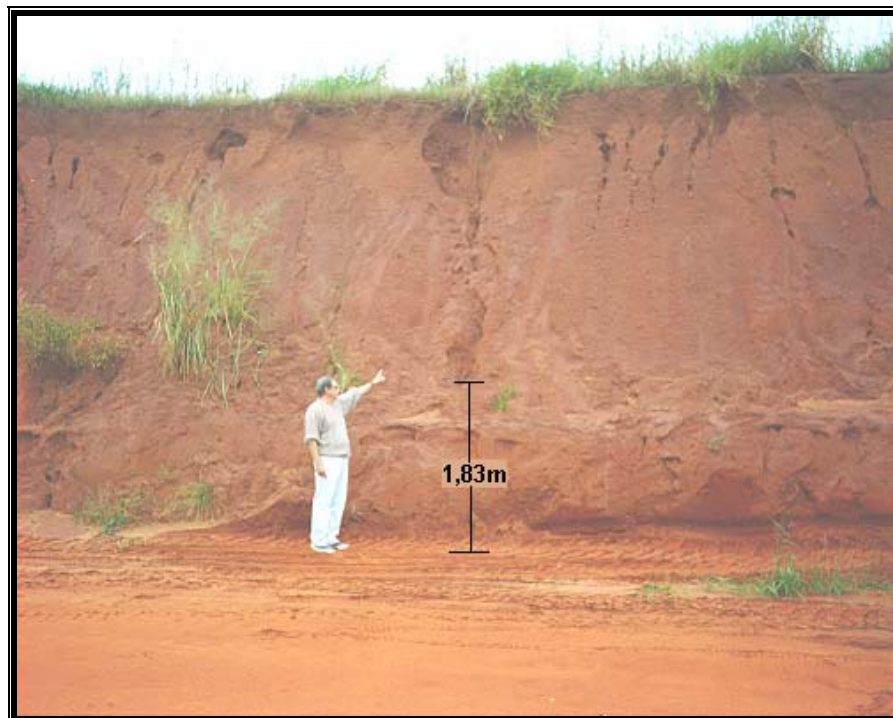
Figura 5.14 – Material inconsolidado residual da formação Santa Rita com feições erosivas ao longo do talude Fonte: Lorandi et al (1999).
