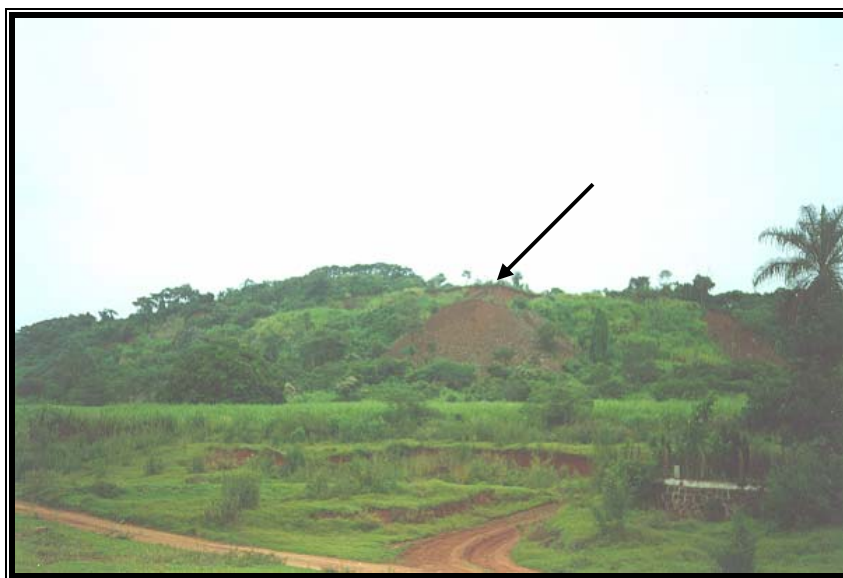
Figura 7.1 – Ao fundo, pedreira de extração de diabásio com relevo típico de solos residuais rasos originários de rochas magmáticas básicas da região.
