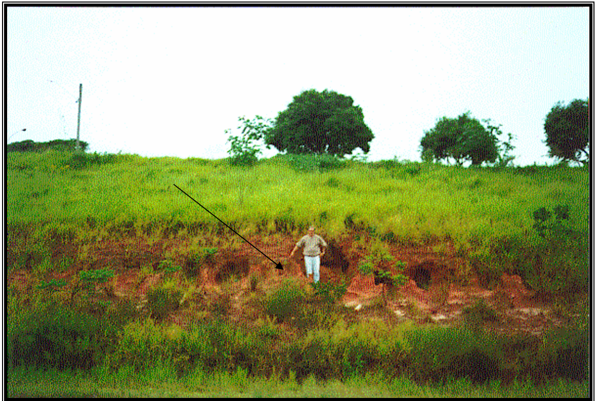
Figura 511 – Perfil de alteração da Formação Pirambóia, material residual típico mostrando feições de erosão na base do talude
