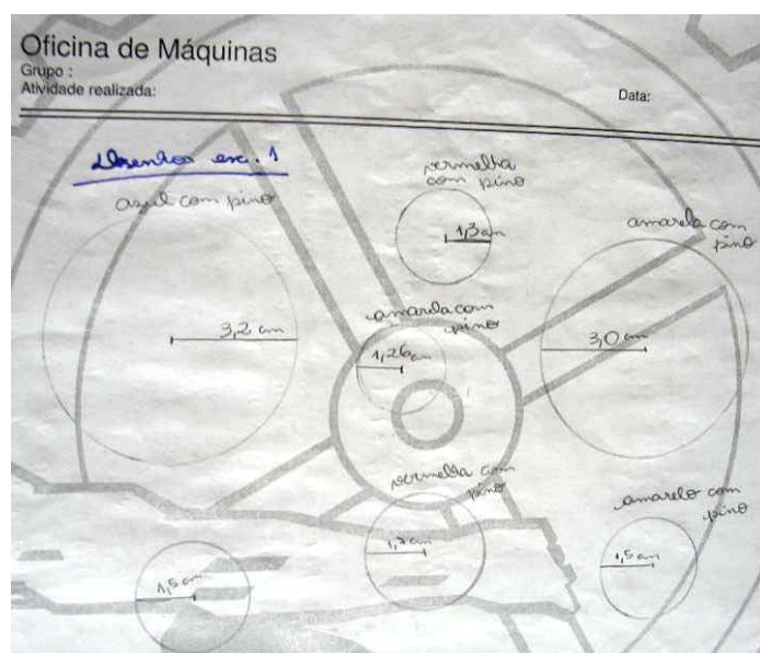
Figura 86: Representação gráfica das roldanas do kit Marklin.
