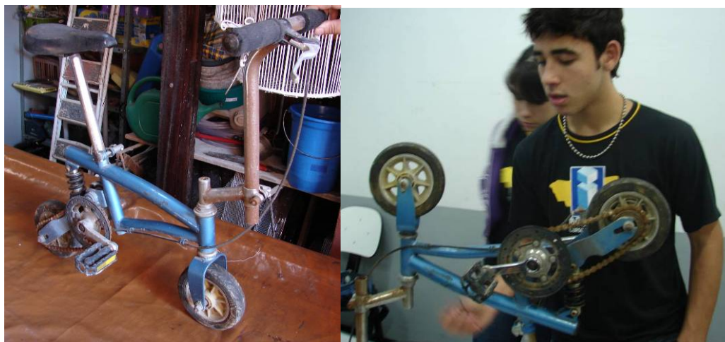
Figura 21: Alunos estudam uma bicicleta com uma roda pedaleira de 28 dentes e um pinhão livre de 16 dentes.
