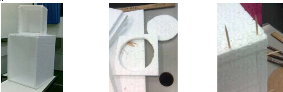
Figura 215: Estrutura do moinho de vento produzida com isopor e palitos de dente.
