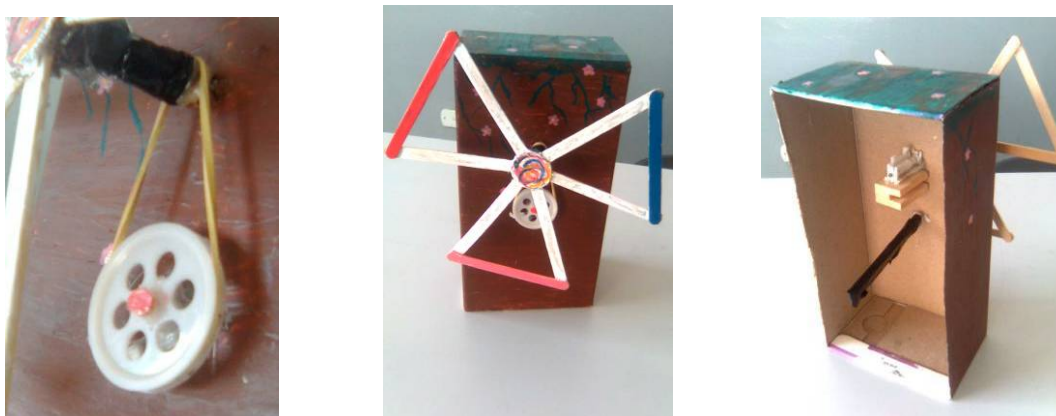
Figura 225: Ventilador construído com uma caixa de sapatos, palitos de sorvete e duas polias ligadas por um elástico.
