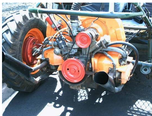
Figura 5: Transmissão por movimento de rotação do motor de uma “gaiola” de corrida.
