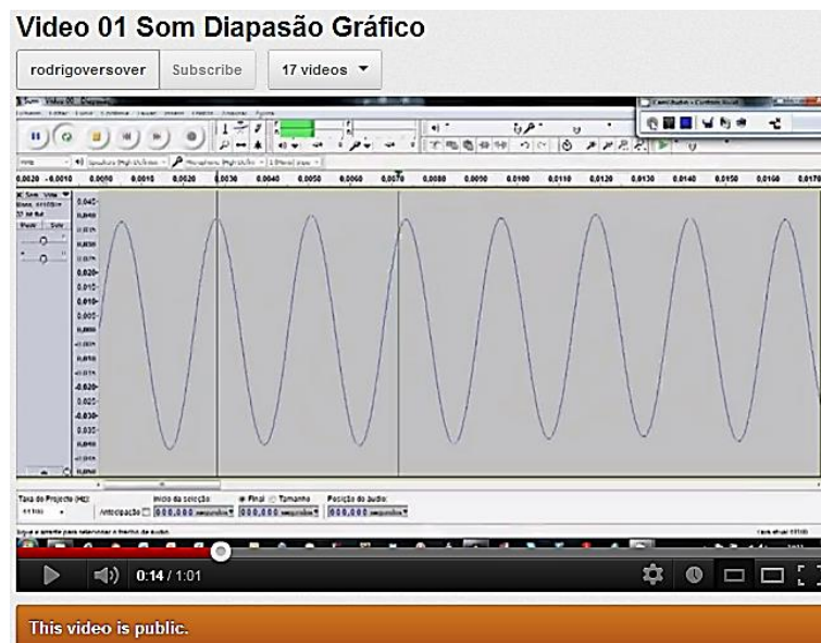
Figura 4.10 – Figura de parte do Vídeo 01. Nesse momento, apresentamos aos alunos o gráfico de pressão da onda sonora gerada pelo diapasão quando colocado diretamente no microfone.
