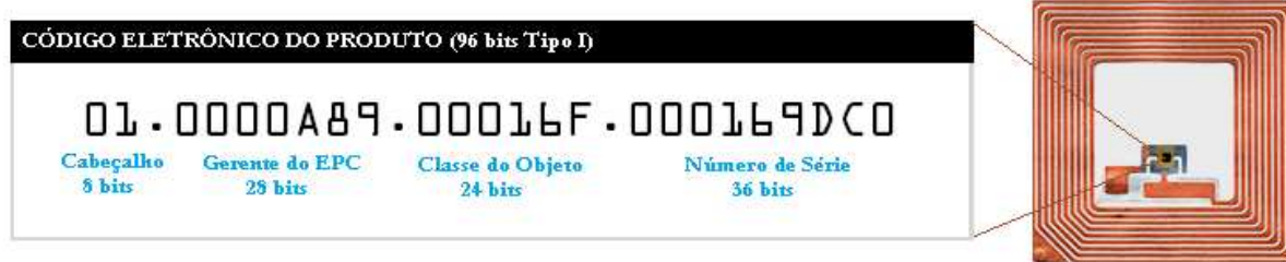
Figura 3: Representação do número EPC dentro da tag RFID
