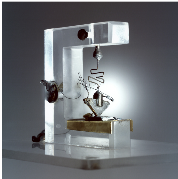
Figura 2.1: Réplica do primeiro transistor fabricado por Brattain, Shockley e Bardeen.
