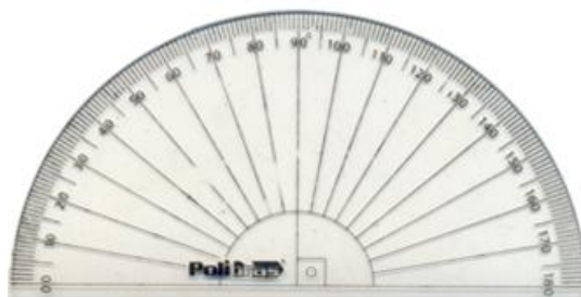
Figura 19: Transferidor de acrílico mais simples
