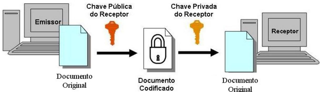
Figura 15 - Criptografia assimétrica.
