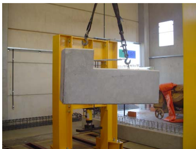
Figura 3-8 – Içamento do elemento com trecho de pilar.
