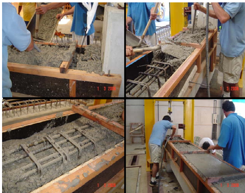
Figura 3-13 – Concretagem do topo da viga.
