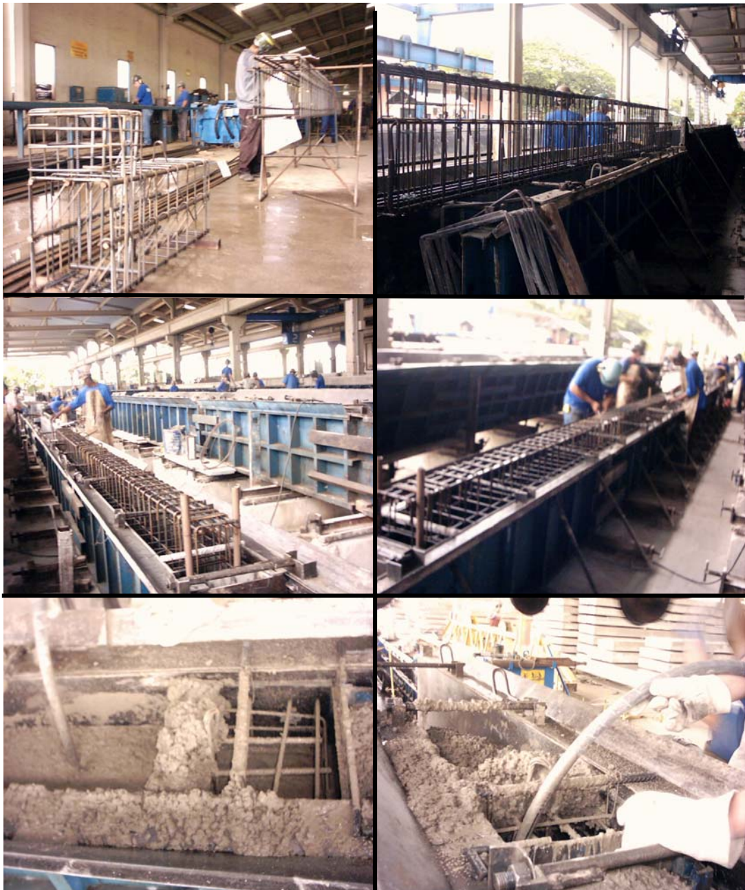
Figura 3-6 – Fabricação do modelo na fábrica em São José do Rio Preto.
