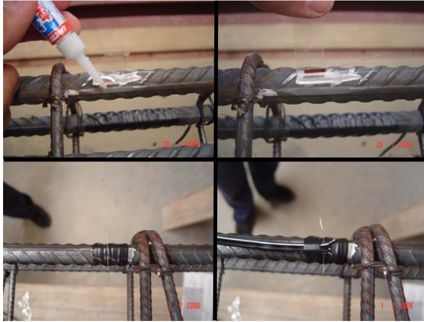
Figura 3-15 – Colagem de strain gages .
