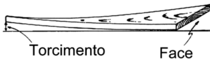
Figura 4.17. Medição do torcimento. Fonte: Southern Pine Inspection Bureau (1994).
