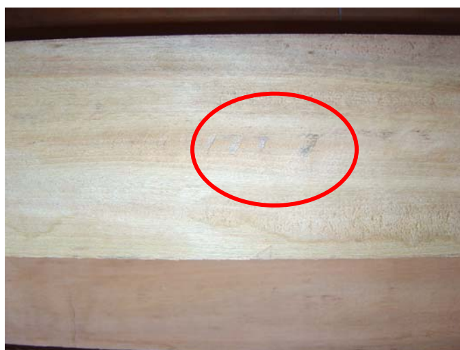
Figura 4.19. Fissuras de compressão.
