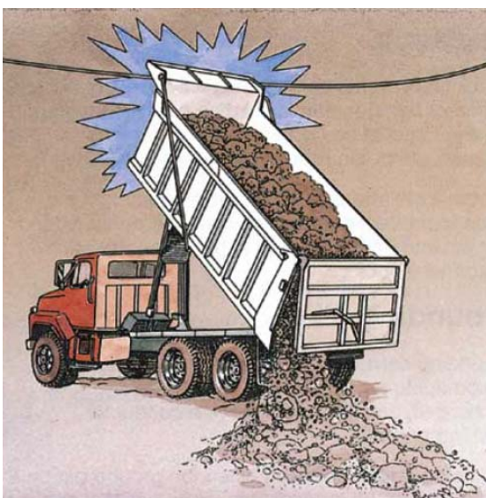
Figura 4.7- Caminhão basculante em contato direto com linha aérea de energia não isolada (Elcosh, 2000).
