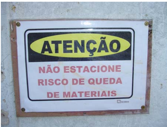
Figura 5.8 – Sinalização de segurança contra risco específico (queda de materiais).
