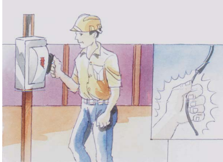
Figura 4.2 - Contato elétrico direto (Fundacentro, 2004).
