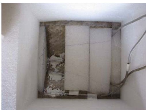
Figuras 130: Isolamento Térmico das Células-Teste
