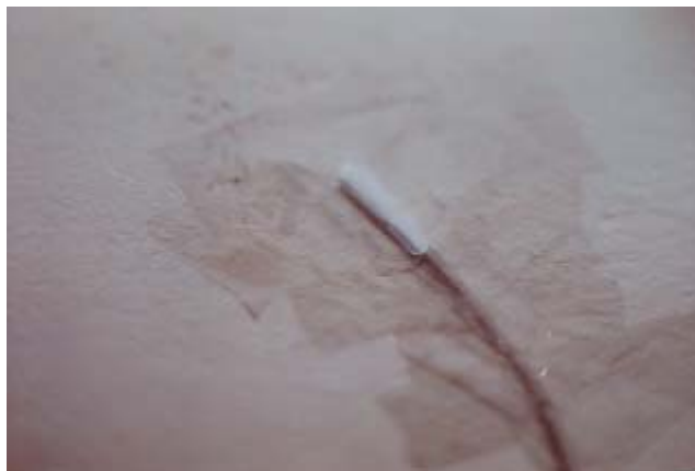
Figura 3.10: Ponteiro metálico preenchido com pasta térmica e fixado na laje com fita adesiva e fio de nylon
