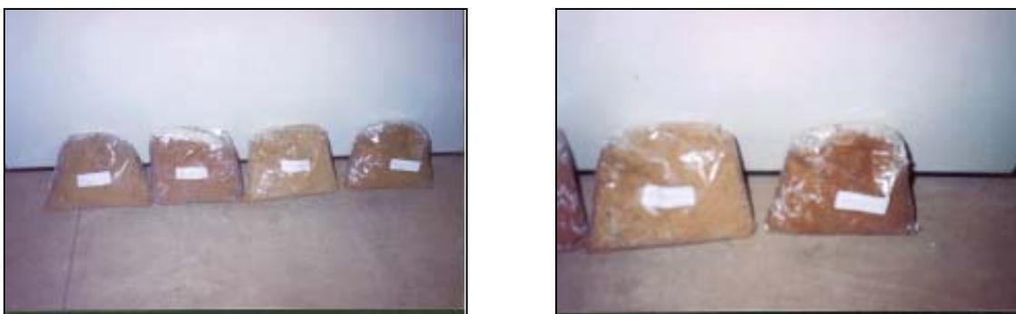
**Figura 30.** Argilas que integram a mistura da massa para produção da telha cerâmica (CCB, 2003).
