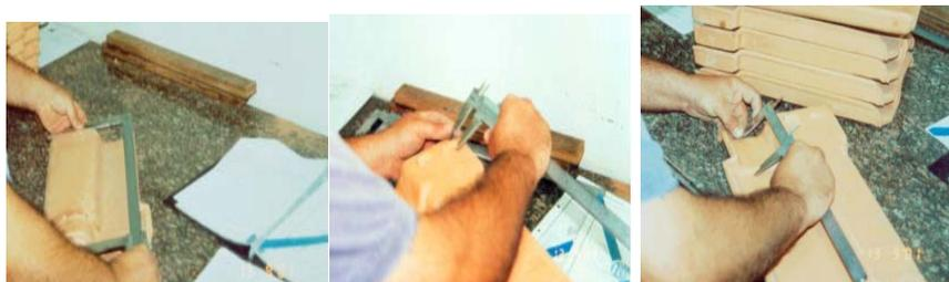
**Figura 53.** Determinação do dimensional dos corpos-de-prova dos produtos acabados fabricados pelas empresas cerâmicas (CCB, 2003).
