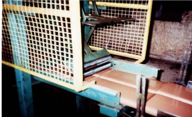
**Figura 20.** Apresentação do equipamento cortadeira estrela para o corte dimensional do bastão das telhas cerâmicas (BONFANTI, 2003).
