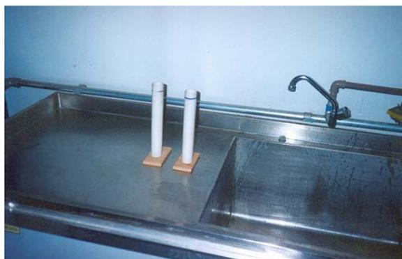
**Figura 48.** Determinação da impermeabilidade após a queima a 900°C NBR 13.582/97 (CCB, 2003).
