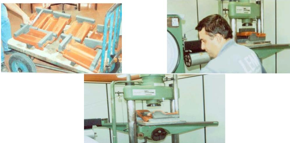
**Figura 50.** Determinação da resistência à flexão dos corpos-de-prova dos produtos acabados fabricados pelas empresas cerâmicas (CCB, 2003).
