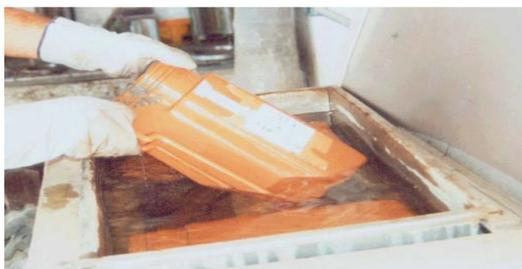
**Figura 49.** Determinação da absorção de água dos corpos-de-prova dos produtos acabados fabricados pelas empresas cerâmicas (CCB, 2003).
