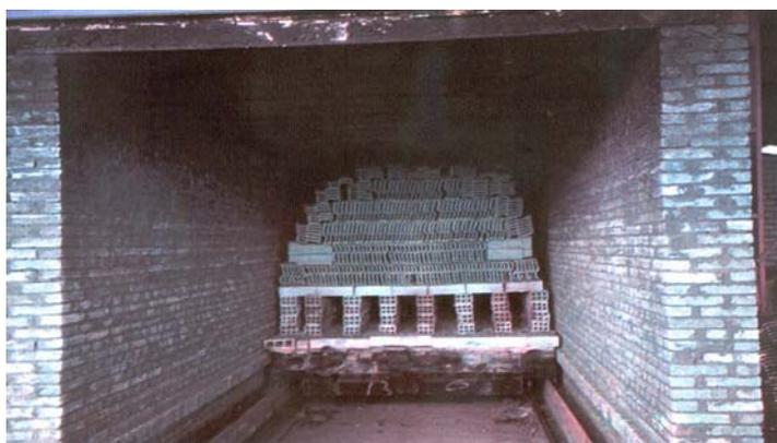
**Figura 26.** Demonstração de um Forno Hoffmann, tipo semicontínuo (Minerais do Paraná, 1997).
