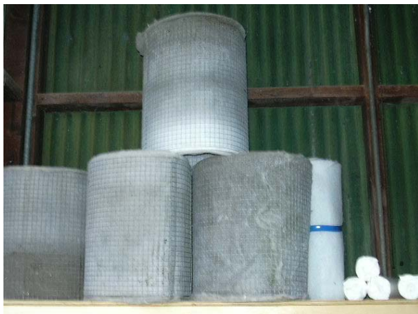
Figura 4.35 Filtros internos ao tanque
