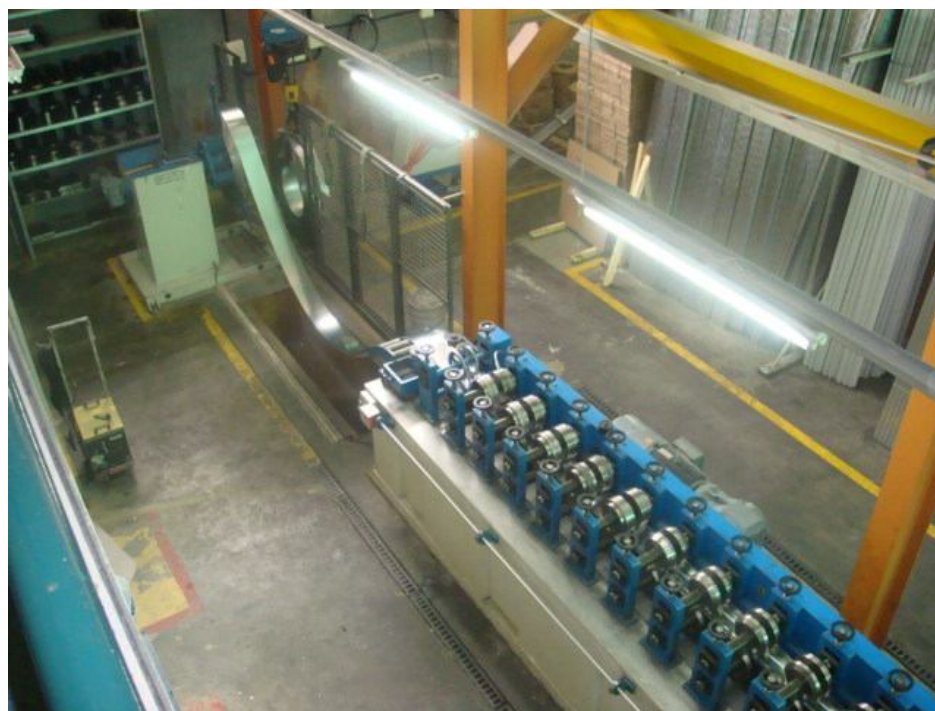
Figura 68: Máquina de maior porte sendo alimentada pela bobina de aço
