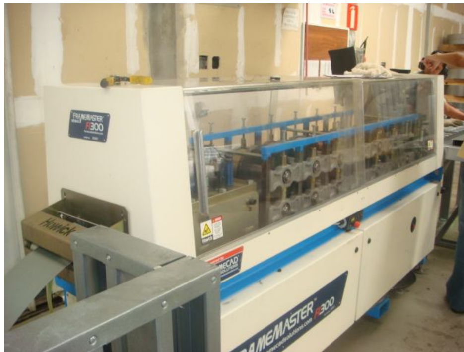
Figura 67: Máquina utilizada para converter o aço das bobinas nos perfis do LSF
