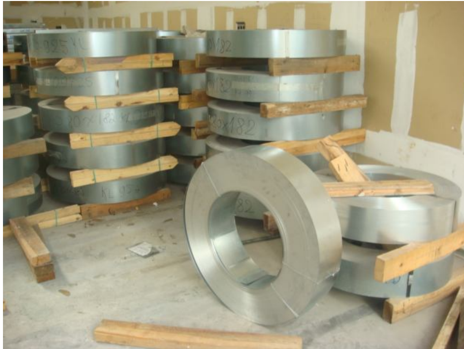
Figura 66: Bobinas de aço utilizadas para a fabricação de perfis do LSF
