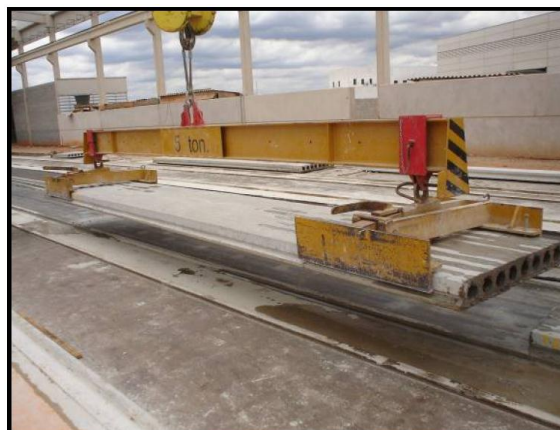
Figura 3. 8 – Processo de retirada das lajes da pista de protensão (FONTE: Petrucci, 2009).
