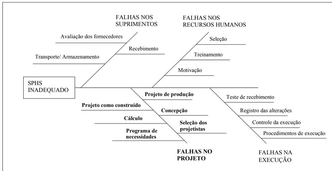
**Figura 2.4** – Identificação das causas de um sistema predial inadequado
