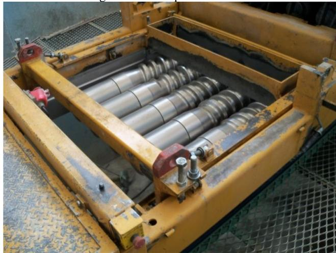
Figura 2.4 – Fabricação de lajes em pista moldadora.
