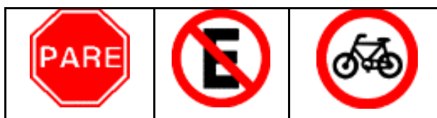
Figura 31 - Alguns exemplos de sinalização de regulamentação
