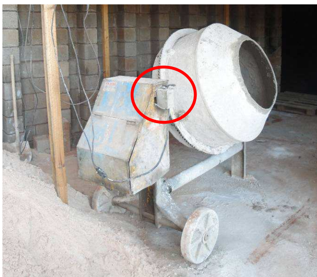
Figura 6.128 – Dispositivo de acionamento de betoneira – Obra 1
