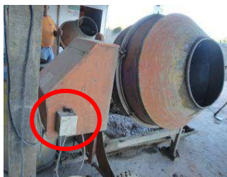
Figura 6.130 – Chave liga-desliga para betoneira – Obra 2
