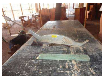
Figura 6.125 – Coifa protetora para serra circular – Obra 6
