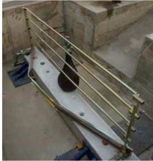
Figura 4.8 - GcR em aço submetido a ensaio dinâmico
