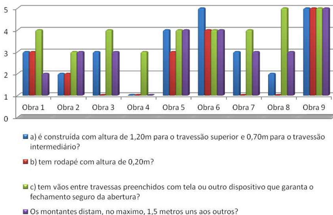
Figura 6.167 – Notas da lista de verificação por obra – Sistema guarda-corpo e rodapé
