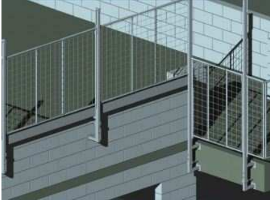
Figura 4.28 – Primeira posição de proteção do sistema ScanMetal
