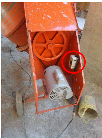
Figura 6.140 – Dispositivo de acionamento de betoneira 200L– Obra 7
