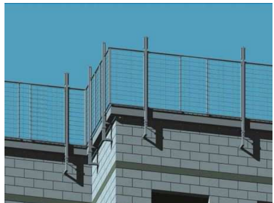
Figura 4.31 – Uso de calhar para evitar queda de materiais no sistema ScanMetal
