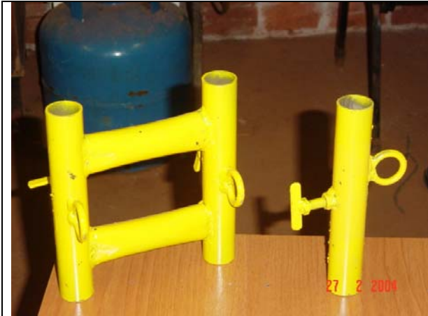
Figura 46 – Componente criado pela empresa C7 fixado em armaduras de pilares durante as atividades de concretagem, armação e execução de formas
