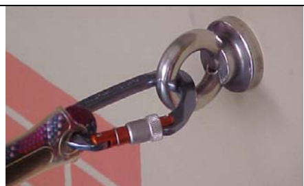
Figura 10 - Fixação do cabo-guia através de mosquetão em ponto de ancoragem
