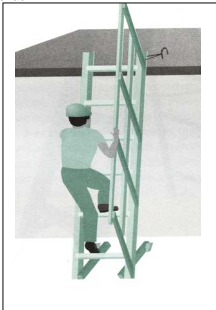
Figura 1 - Escada de mão com Guarda-corpo-Rodapé Fonte: Sampaio (1998b, p. 141)
