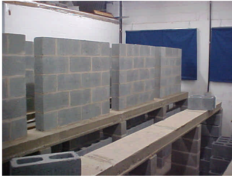
Figura 54: Paredes executadas sobre lajes e cortinas cobrindo as janelas para impedir interferência do sol em algumas paredes
