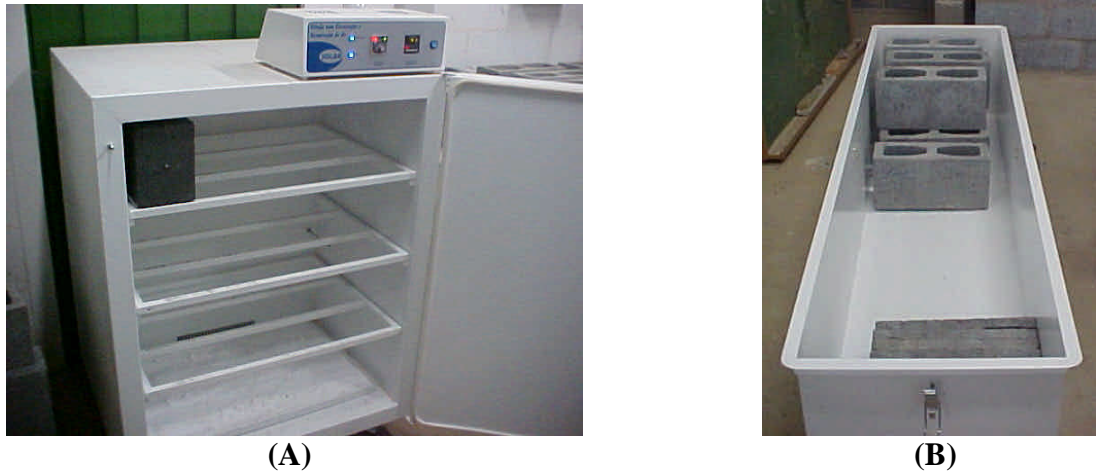
Figura 46: (A) Estufa para secagem dos corpos-de-prova; (B) Caixa hermeticamente fechada para preservar a umidade baixa dos blocos
