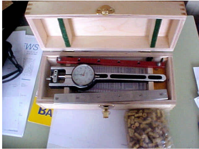
Figura 19: Kit para ensaio de retração: Demec Gauge, barra padrão de invar, gabarito para colagem de pastilhas
