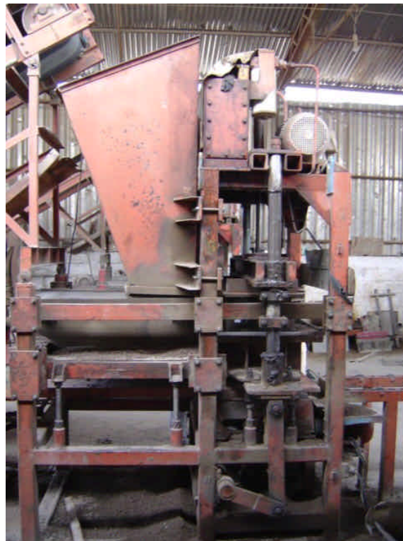
Figura 37: Equipamento utilizado para se fazer a prensagem (necessário um operador para executá-la)
