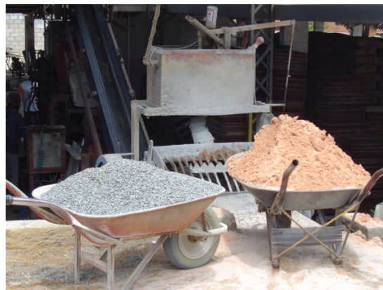
Figura 35: Material coletado (pedrisco e areia) em carrinhos de mão para a mistura
