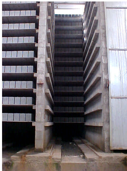
Figura 29: Local de cura dos blocos
