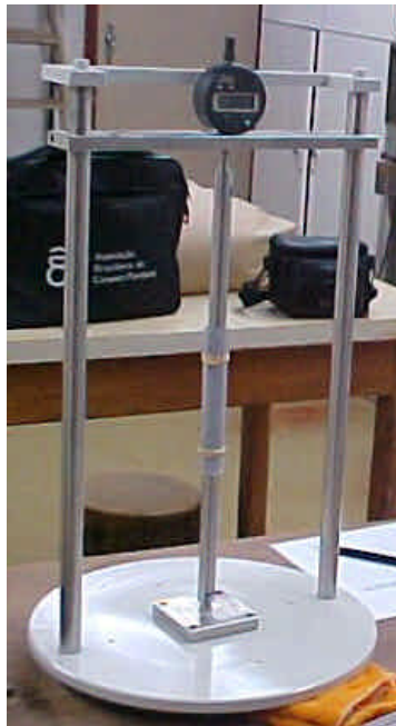
Figura 18: Aparelho comparador com barra padrão
