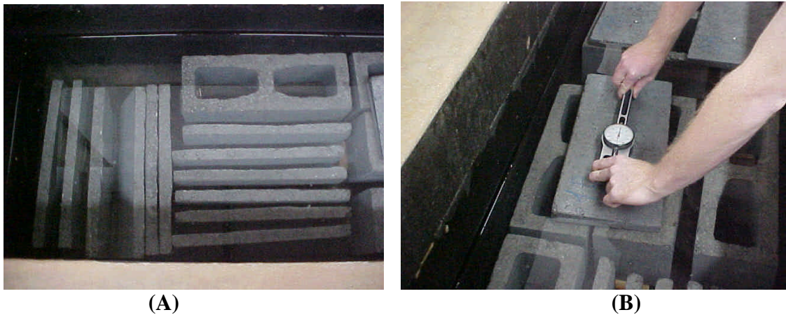
Figura 44: (A) Corpos-de-prova imersos num tanque com água; (B) Obtenção de leitura inicial com o corpo-de-prova imerso no tanque
