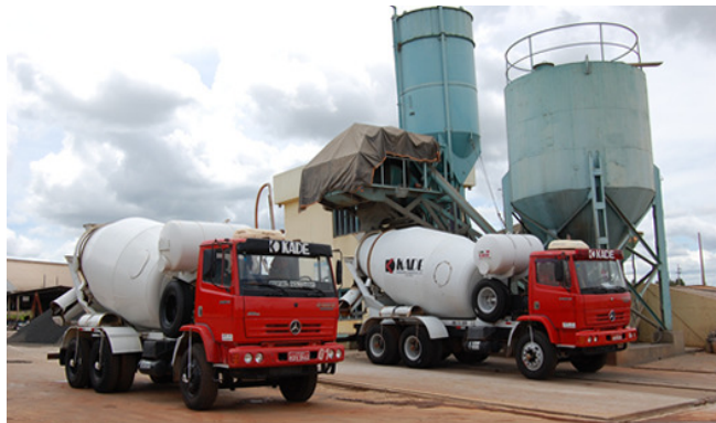
Figura 9 - Exemplo da produção do concreto em usinas e transportado por caminhão betoneira
