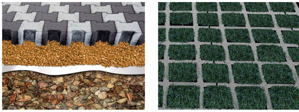
Figura 20 – Piso intertravado e concregrama
