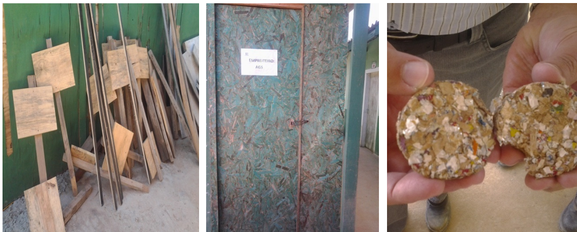
Figura 41 – Reaproveitamento no canteiro e madeira reciclada
