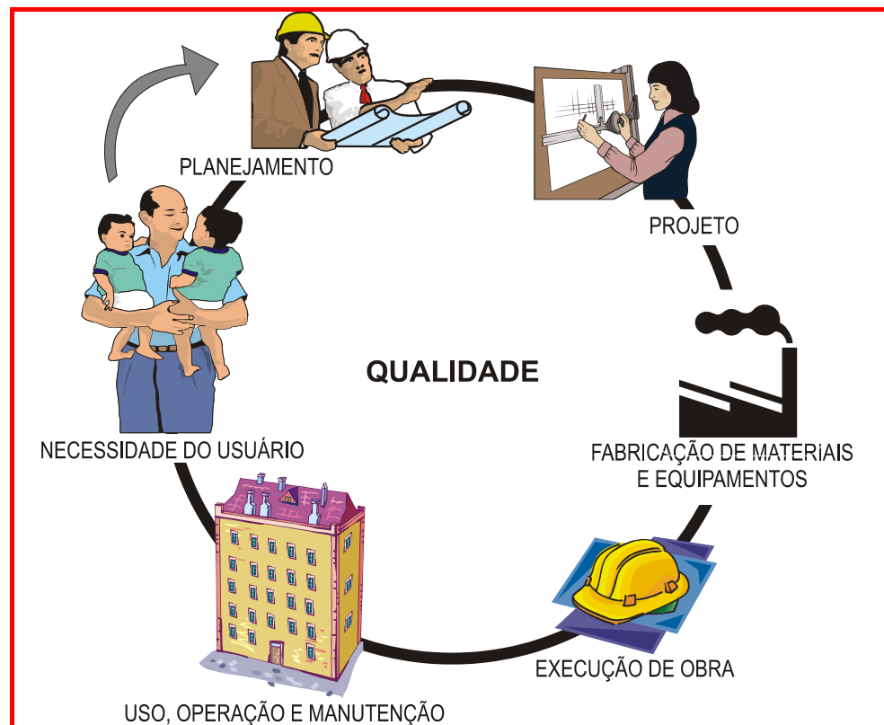
Figura 3 Ciclo da Qualidade na Construção Civil - Adaptada por esta autora Fonte: SOUZA et al., 1995, p. 41.
