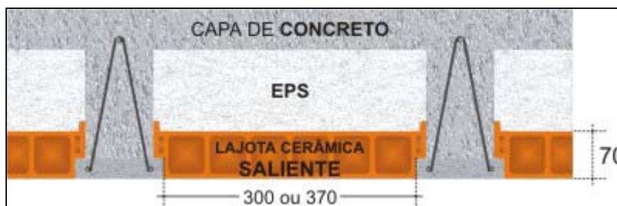
Figura 2.5– lajota saliente para composição com blocos de EPS.
