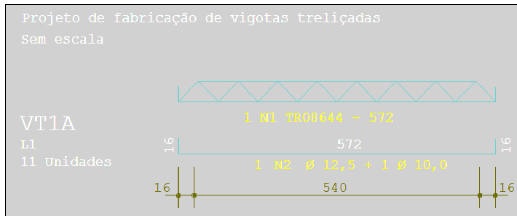
Figura 5.9 – detalhamento das armaduras das nervuras. (Software TQS – versão 11.3).
