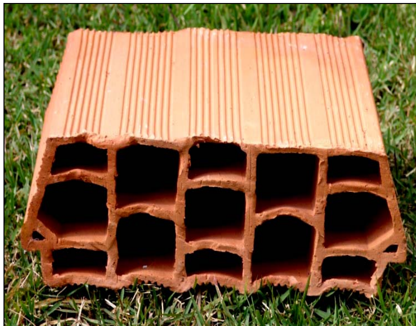
Figura 2.11- Elemento de enchimento cerâmico. (arquivo do autor)
