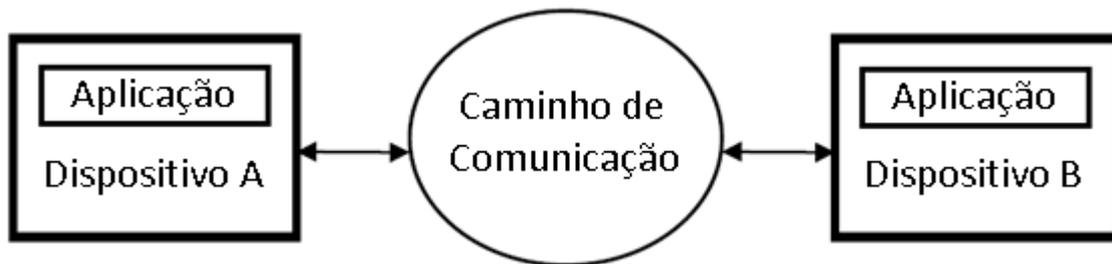
Figura 2 – Caminho de Comunicação entre dois dispositivos que utilizam o RFCOMM (BLUETOOTH SIG, 2003).
