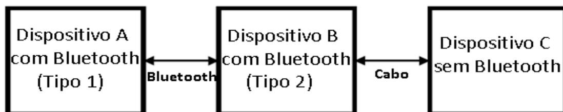
Figura 3 – Caminho de Comunicação entre um dispositivo comum e um dispositivo de rede (BLUETOOTH SIG, 2003).
