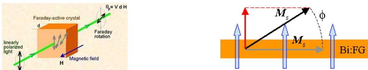
Figura 18. Esquerda: Luz polarizada incidente em um cristal que exibe o efeito Faraday, submetido a um campo magnético. Direita: a componente do campo perpendicular ao plano do filme causa uma rotação ( \theta_F ) da direção de polarização.
