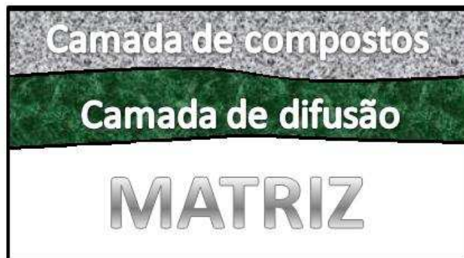
Figura 16 – Esquema das camadas formadas na nitretação.
