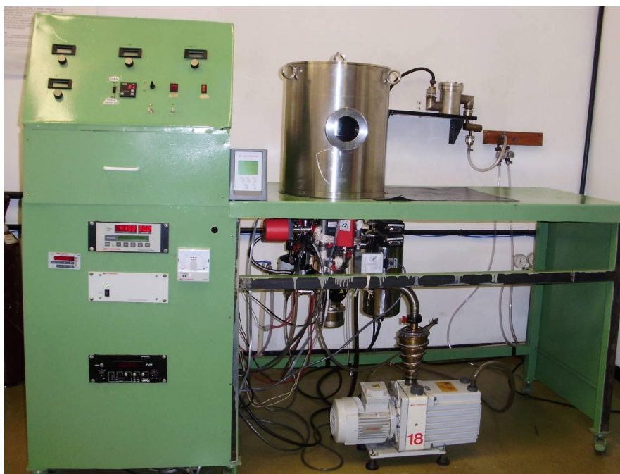
Figura 12: Foto do Nitretador utilizado neste experimento, aberto para visualização dos componentes internos.
