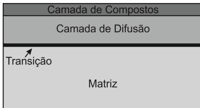
Figura 9: Esquema das regiões formadas após a nitretação.
